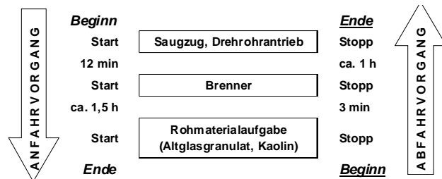
Abb. 6: Ablaufschema des An- und Abfahrvorgangs der Glasschäumenanlage
